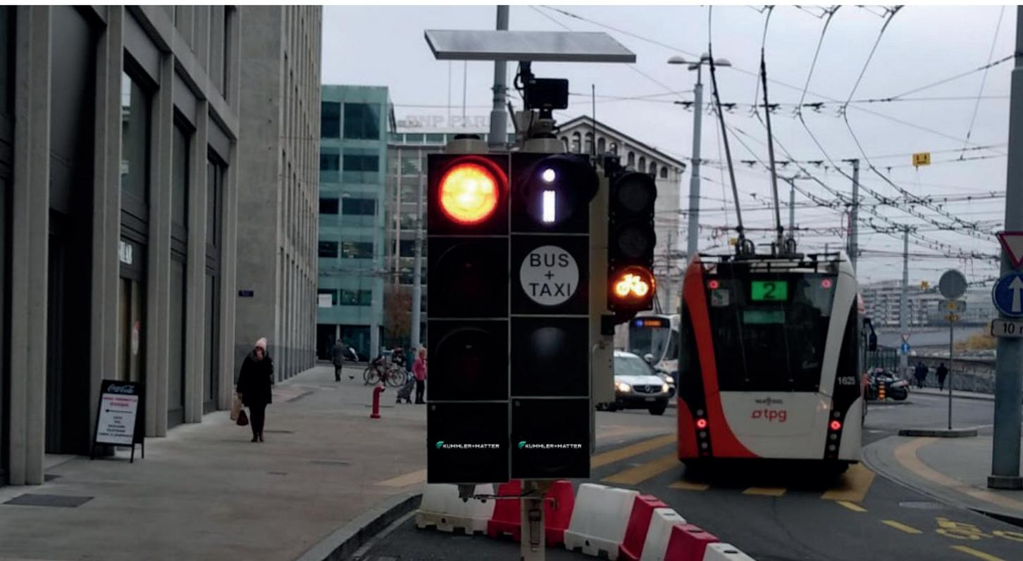
Un récepteur GPS pour la géolocalisation de l'installation et la synchronisation avec l'horloge atomique, est compris dans la fourniture standard, tout comme un détecteur de véhicules hors-sol, ainsi qu'un routeur 3G/4G pour communication avec l'extérieur extérieure. Synchronisation des plans de feux avec les contrôleurs de carrefour existants avec TXsync.
